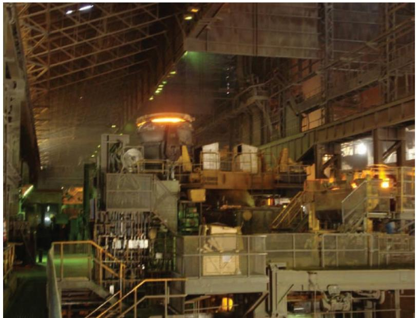
metálica y en su interior revestida por material refractario, ya que el acero fundido tiene una temperatura superior a 1680 ° C. El proceso se inicia en el colado del horno, pasando por un horno de afinado donde se agregan ferroaleaciones hasta conseguir la calidad deseada, por último llegará a la colada continua para ser procesado y culminar en una barra, que luego se lamina, se perfora y termina en un producto para la industria.
