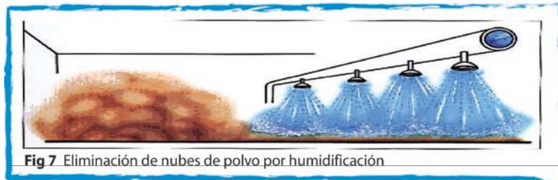
Fig 7 Eliminación de nubes de polvo por humidificación
